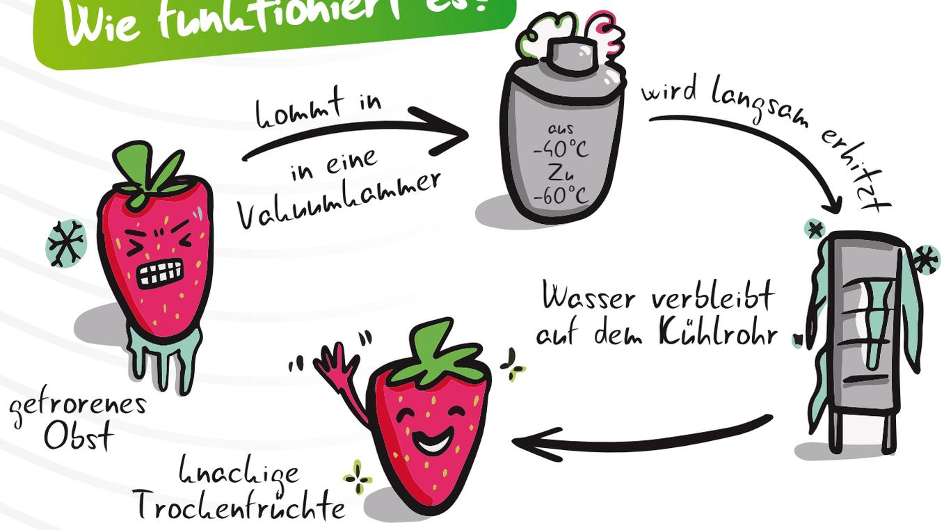
**BEI DER GEFRIERTROCKNUNG** legen wir die gefrorenen Früchte in eine Vakuumkammer, in der die Temperatur zwischen  $-60$  und  $-40^{\circ}\text{C}$  liegt, und erhitzen die Früchte langsam, wodurch das Wasser aus den Früchten verdunstet. Das Wasser bleibt in Form von Eis am umgebenden Kühlrohr hängen und die Früchte bleiben vollständig getrocknet.
